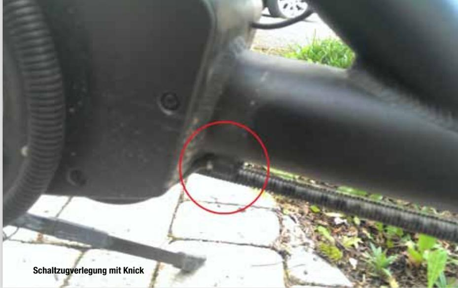
Schaltzugverlegung mit Knick
